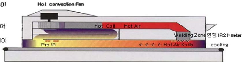
Slide Zone은 예열온도, Welding 온도 특성에 순간 온도 가속 능력이 우수하며, Pre Heating의 구간 시간설정이 커브 특성을 자유롭게 구현이 가능합니다.
